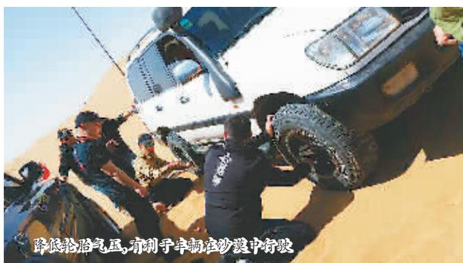
降低轮胎气压，有利于车辆在沙漠中行驶
